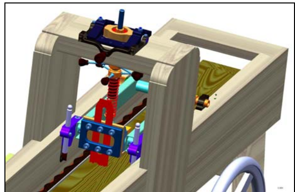
Figur 60: 3d-vy av maskinhuset med skärelement Bild: Bengtsson (2009)
