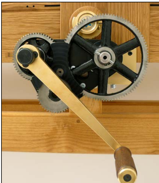
Figur 72: Drivsystemet (våxellåda med vev) Bild: Erckrath (2009)
