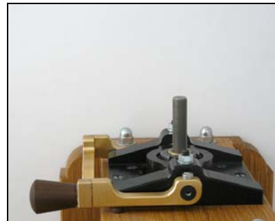
Figur 70: Lyftarm på toppen av maskinhuset (profiljärnet nedfällt) Bild: Erckrath (2009)
