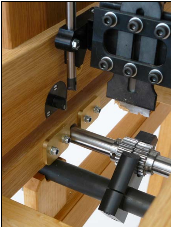
Figur 69: Skärelement samt driftsystem (maskinlåda utan arbetsbord) Bild: Erckrath (2009)
