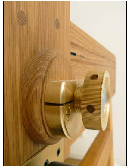
Figur 75: Justerbeslag till sidoavkännare Bild: Erckrath (2009)
