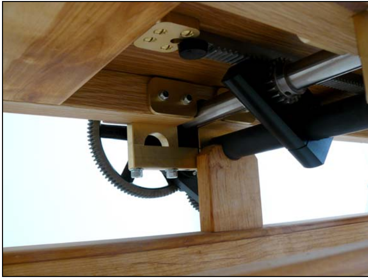
Figur 74: Drivsystemet nedifrån (kuggstång/ kugghjulordningen med fingerskydd) Bild: Erckrath (2009)
