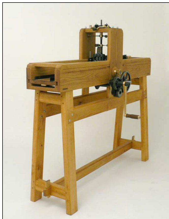
Figur 58: Hopp- och flamlistapparat, byggd i samband med examensarbete Bild: Erckrath (2009)
